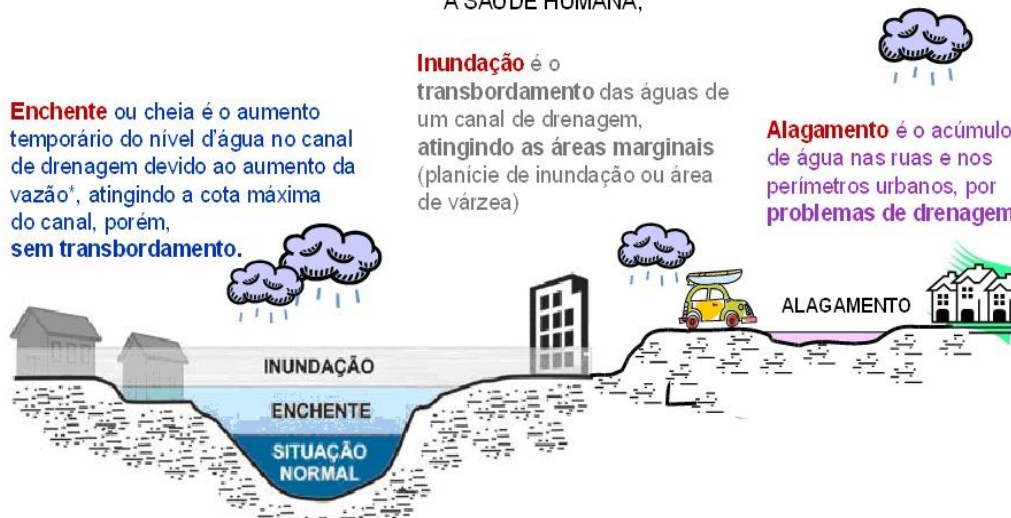
Figura 3: Diferenciação entre enchente, inundação e alagamento. FONTE: Defesa Civil de São Bernardo do Campo, SP.
